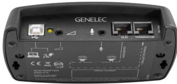
図 59. GLM ネットワーク・アダプターの接続端子（左から、コンピューターまたは電源アダプターへ接続する USB 端子、ハードウェア・レベル・コントローラー入力端子、GLM 測定用マイクロホン入力端子、GLM ネットワーク端子、ターミネーター端子）
