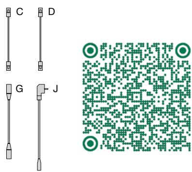
12. ケーブル C、D、G を用いてアンプ同士を接続し、ケーブル J を電源に接続します。設置および接続方法の詳細は、上記の QR コードから 8381A オペレーティング・マニュアルおよび GLM システム・オペレーティング・マニュアルをご参照ください。
