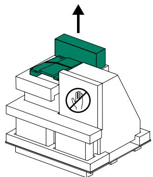
2. アクセサリー・ボックスを取り出し、傾斜ウェッジの結束をハサミでカットした後、傾斜ウェッジを取り出します。
