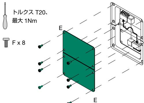
9. 8 個のトルクス・ネジ (F) で保護プレート (E) を取り付けます。ネジの締め過ぎにご注意ください。
