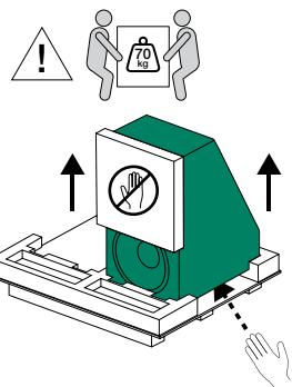
7. ビニール袋を取り外したトップ・エンクロージャを慎重に持ち上げ、ボトム・エンクロージャの上に設置します。
