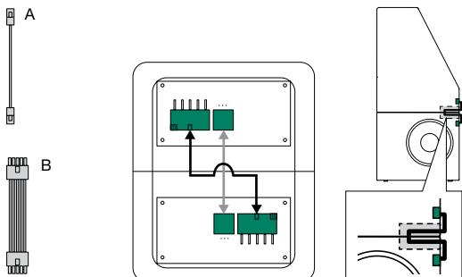
8. ケーブル A とケーブル B でトップ・エンクロージャとボトム・エンクロージャを接続します。接続後、エンクロージャ間の隙間にケーブルを慎重に押し込みます。
