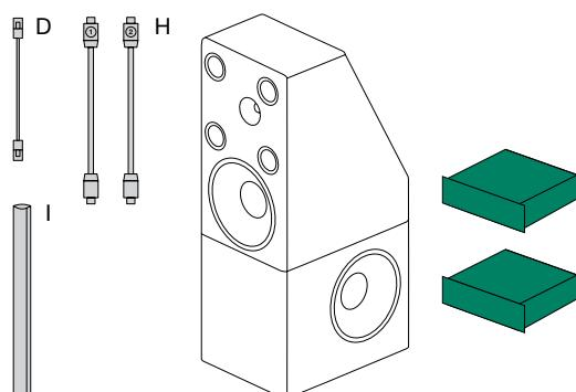
11. ケーブル D とケーブル H を使用して、アンプとボトム・エンクロージャを接続します。アンプ 1 と入力 1、アンプ 2 と入力 2 を接続してください。アンプとエンクロージャ入力に記載されるシリアル番号が一致することをご確認ください。(オプション) ケーブル D およびケーブル H には、付属のスリーブ (I) を被せることができます。
