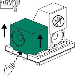
5. スピーカーの設置位置を決め、ボトム・エンクロージャを取り出し、ビニール袋を取り出し設置位置まで運搬します。
