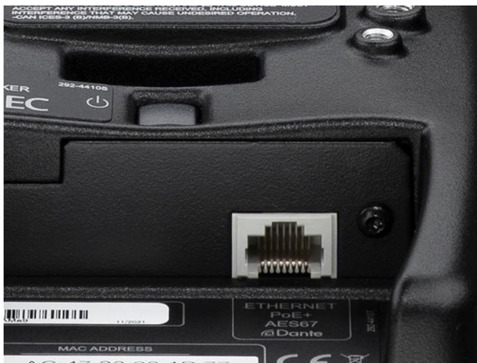
4410A はリアパネルに RJ45 による LAN 端子を装備。CAT5 (CAT5e 以上) ケーブルを用いたこの端子は Dante と AES 67 / ST 2110 AoIP ストリームに対応し、最大 8ch のオーディオ・ストリームを非圧縮でサポート致します。
