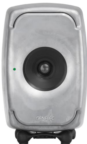
●最大 SPL レベル：104dB/110dB (1/0.5m) ●周波数応答：45Hz-37kHz (-6dB) ●周波数応答の精度：±1.5dB (58Hz - 20kHz) ●自己生成ノイズ (A 特性、1m)：0dB ●ベース・ドライバー、デュアル：142×76mm 楕円形 ●ミッド・ドライバー：90mm 同軸 ●トレブル・ドライバー：19mm 同軸 ●アンプ出力：72W + 36W + 36W ●オーディオ入力：XLR アナログ、AES/EBU ●：(Iso-Pod™含む)：H350×W189×D212mm ●質量：6.2kg
