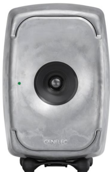
●最大 SPL レベル：110dB/116dB (1/0.5m) ●周波数応答：38Hz-37kHz (-6dB) ●周波数応答の精度：±1.5dB (58Hz - 20kHz) ●自己生成ノイズ (A 特性、1m)：<3dB ●ベース・ドライバー、デュアル：178×97mm 楕円形 ●ミッド・ドライバー：90mm 同軸 ●トレブル・ドライバー：19mm 同軸 ●アンプ出力：250W + 150W + 150W ●オーディオ入力：XLR アナログ、AES/EBU ●：(Iso-Pod™含む)：H370×W237×D243mm ●質量：9.8kg
