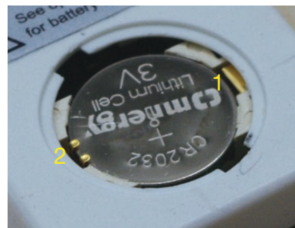
図4：電池を取り除くには、まず右側(1)を持ち上げます。電池を取り付ける場合、まず左側を差し込み、電池の左側が+極の接点の下にはまるようにします(2)。
